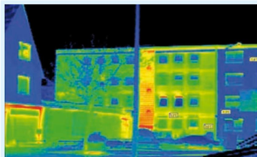
Nürnberg-Laufamholz: In der Mitte ein nicht gedämmter Wohnblock mit Glasbausteinen im Bereich des Treppenaufgangs, rechts ein Teil des selben Gebäudes, der bereits gedämmt wurde
